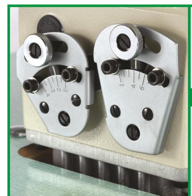
搖桿式差動、針距調整裝置,提供 您充分的差動進給量和輕鬆方便的 調整針距。
